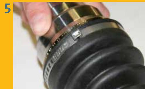
Der Niederhalter des Montagewerkzeugs ermöglicht das zuverlässige Verschließen der Klemme.
