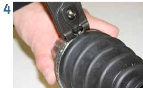
Legen Sie die Klemme um die Manschette und haken Sie den Verschluss in der kleinstmöglichen Position ein. Schließen Sie die Klemme unter Zuhilfenahme der Montagezange.
