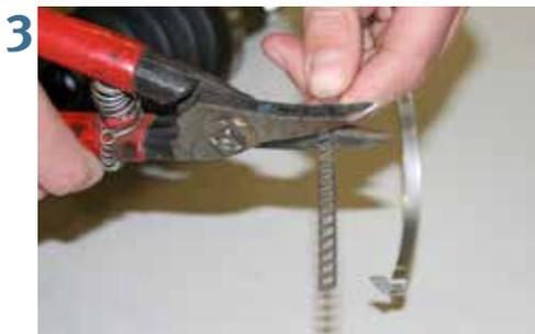
Trennen Sie das überschüssige Material ab. Um mögliche Verletzungen zu vermeiden, entgraten Sie die Schnittkanten mit einer Feile.
