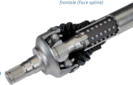
Unité de joint homocinétique avec la technologie Ballspline
