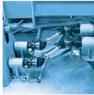
应用于 AAR 万向节的 GKN Driveline TPE 材质密封系统
