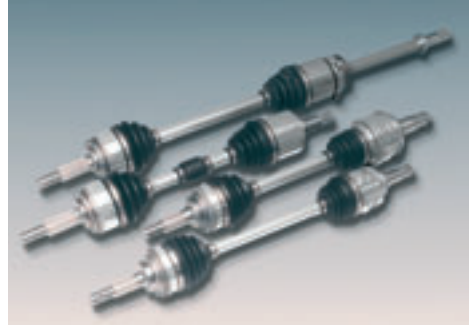
Configurações Típicas de Semi-eixos Homocinéticos (variedade de tipos e tamanhos de juntas)
